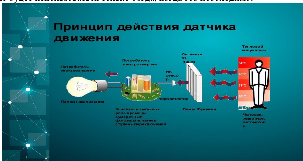
Рисунок 1– Принцип действия датчика движения.
