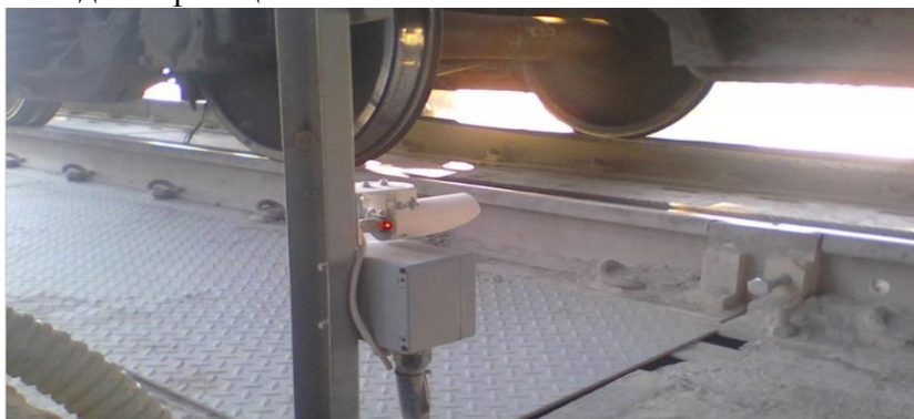
Рисунок 3 – Автоматическое считывание информации на весах
