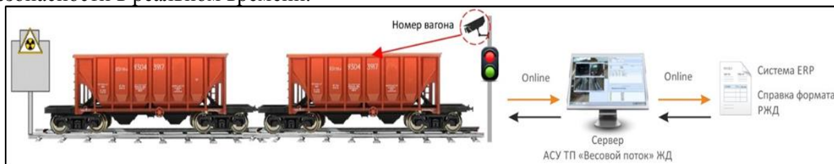
Рисунок 1 – Автоматизация распознавания номеров вагонов
