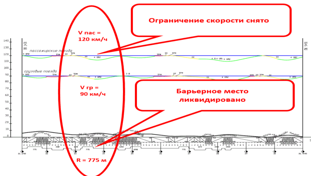
Рисунок 3 – Графики скорости грузовых и пассажирских поездов в четном направлении по II пути, построенные по результатам тяговых расчетов после реконструкции по максимальному варианту
